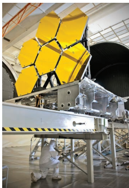
Zes van de achttien spiegelementen worden voorbereid voor een laatste cryogene test op NASA's Marshall Space Flight Center.
