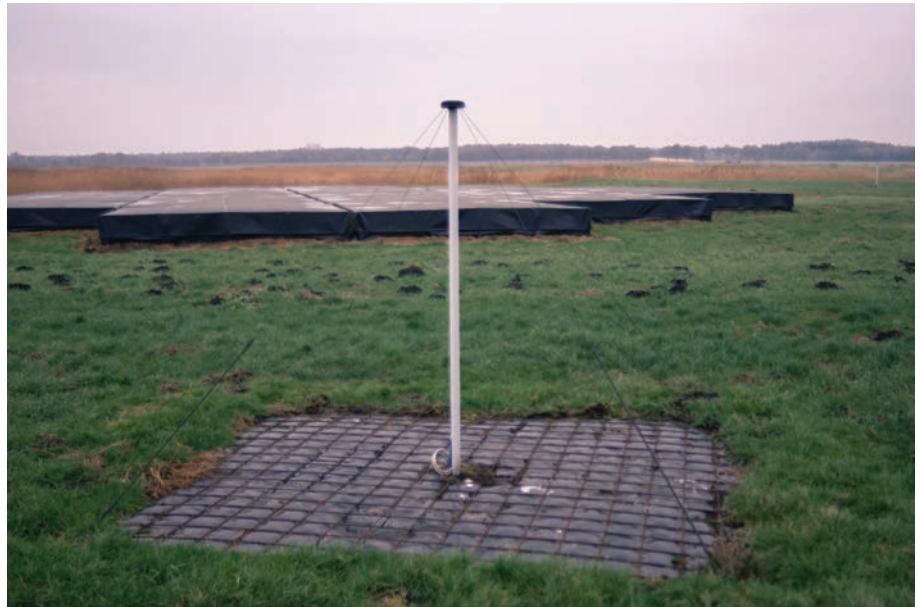
De LOFAR Low Band Antenne. De vier geleidende draden zitten met tentharingen vast in de grond. Het zwarte kopstuk van de antenne bevat de elektronica.
