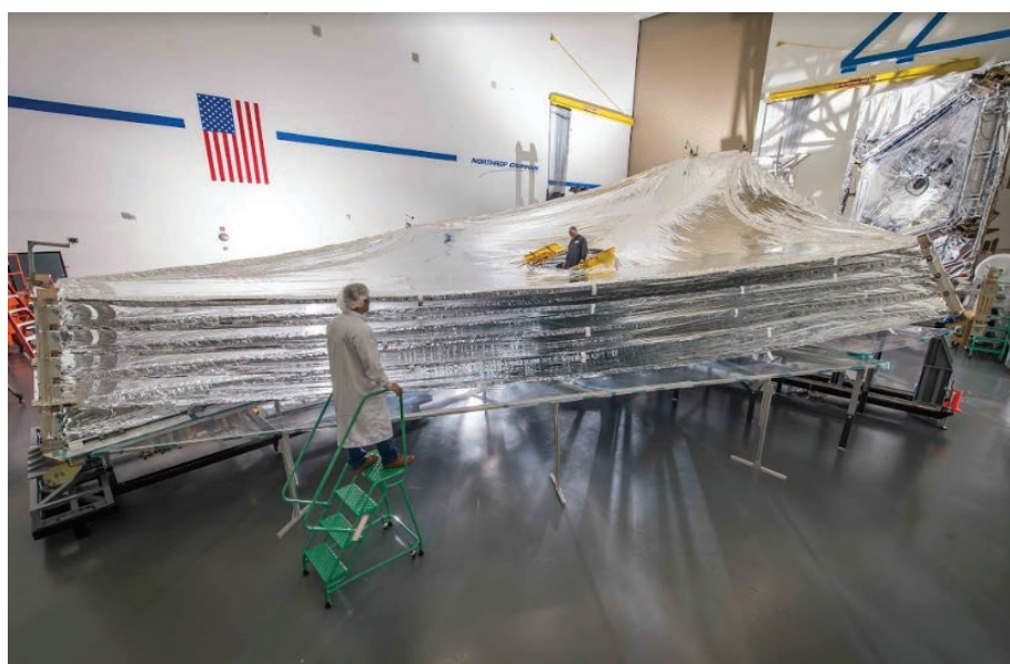
Succesvolle test voor het ontvouwen en aanspannen van het uit vijf lagen bestaande JWST-zonnescherm. Bron: Chris Gunn/NASA
