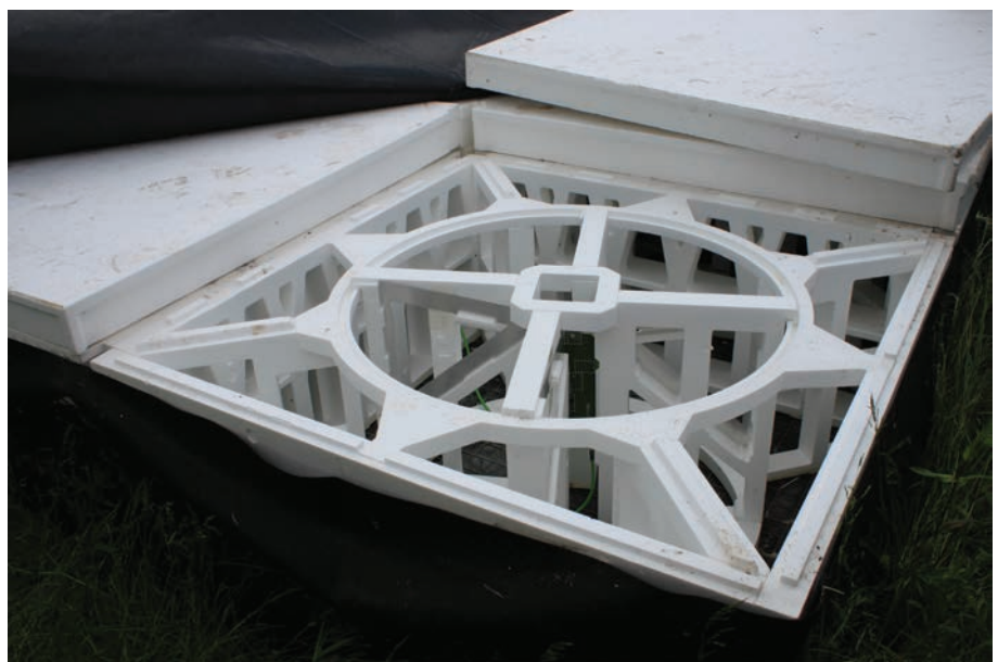
De High Band Antenne zit verborgen onder zwarte overkappingen, die bepaalde storenders uifilteren. Deze antennes werken met metalen plaatjes in plaats van draden. Kraaien uit de omgeving zagen deze zwarte dozen eerst aan voor hooibalen (die ook vaak zwart verpakt worden), gelukkig leerden ze snel af om er met volle kracht op af te vliegen.
